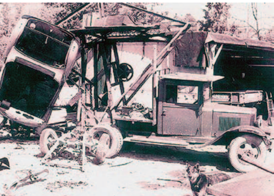
Greuters Autoverwertung (1954) hinter der Kirche in Maur. Der selbst konstruierte Kranwagen auf einem Chevi-Truck war der absolute Fortschritt.
