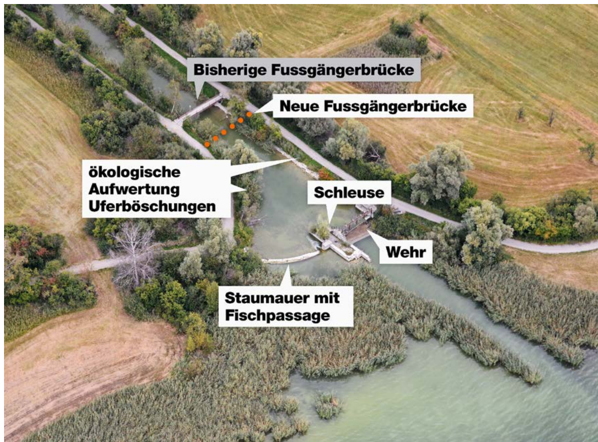
Der Plan zeigt, wie das Wehr instand gestellt werden soll.
